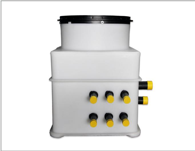
Der Cube Verteilerschacht bietet Sicherheit sowie einen zentralen Ort für die Steuerung und Überwachung des Durchflusses und optimal des Drucks und der Temperatur von geothermischen Wärme- und Kältequellen. Der Cube Verteilerschacht ist aus robustem, 11 mm dickem, widerstandsfähigem Polyethylen geformt und mit bis zu 8 Solekreisläufen zusammen mit einem Sortiment an Zubehör wie Regelventilen, Durchflussmessern, Füll- und Entlüftungsanschlüssen, Manometern und Thermometer erhältlich.
